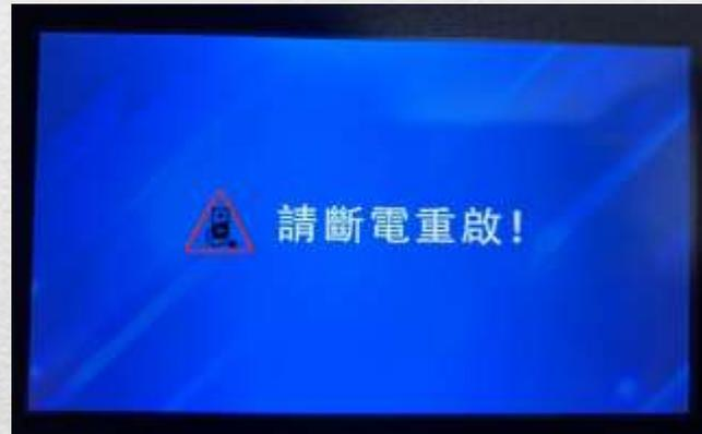
點擊焊點接首頁的切換按鈕，進入過渡頁面。點擊“繼續”，按照系統提示斷電重啟即可切換為清洗模式。
